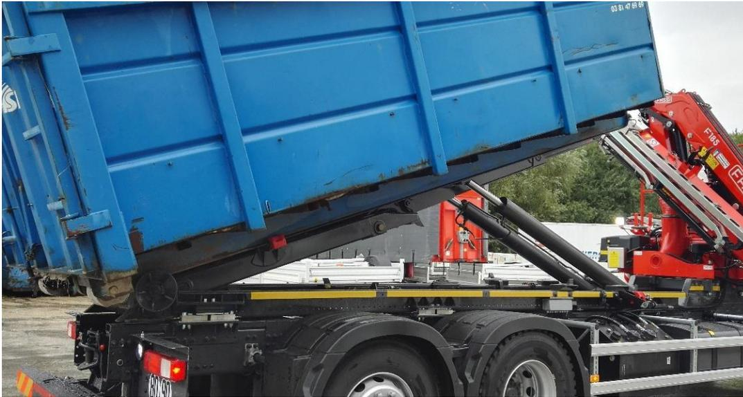
PESAGE STATIQUE SUR APPAREIL A BRAS PAR LEVE DE LA CAISSE
