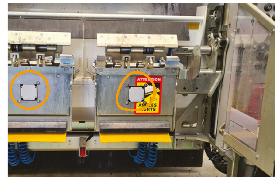
Système RFID UHF à 2 antennes positionnées sur chaque chaise.
